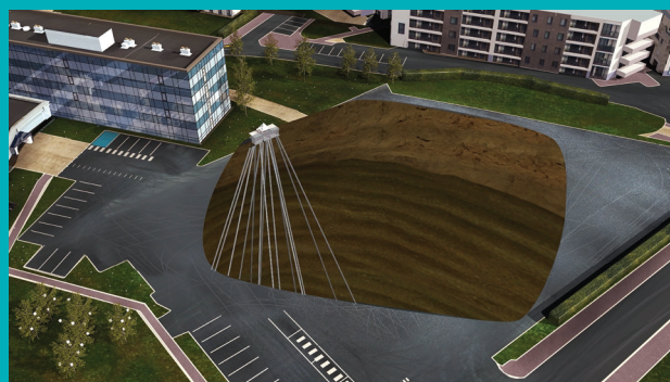
Illustration de la faible empreinte au sol prise par les dix puits géothermiques disposés en étoile conçus par Celsius Energy pour ce projet.
