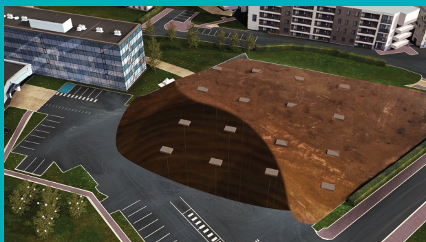
Une image de la place qu'auraient occupé des puits verticaux traditionnels peu profonds.
