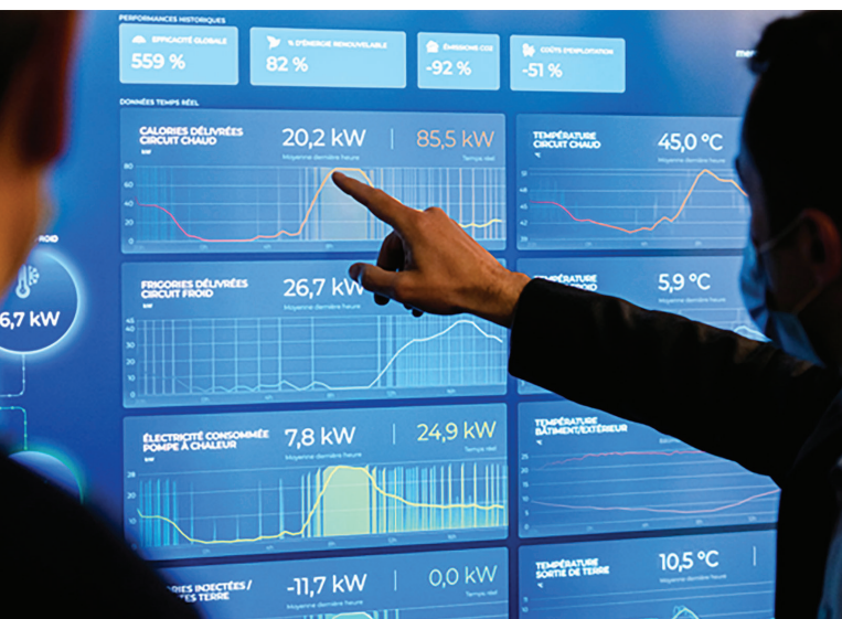
Vue du tableau de bord avec les principales parcelles dans le temps de l'énergie délivrée (chauffage et refroidissement), de l'électricité consommée, de l'énergie souterraine renouvelable produite.
