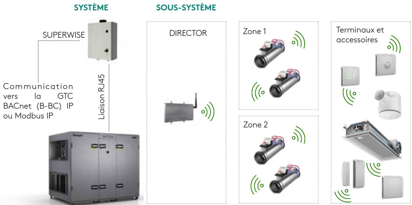
Le coffret de commande est ouvert aux réseaux de communication Modbus TCP ou doté d'une régulation de bâtiment BACnet (B-BC) et d'une passerelle BACnet (B-GW) prêtes à l'emploi, utilisant la révision 14 du protocole BACnet.
