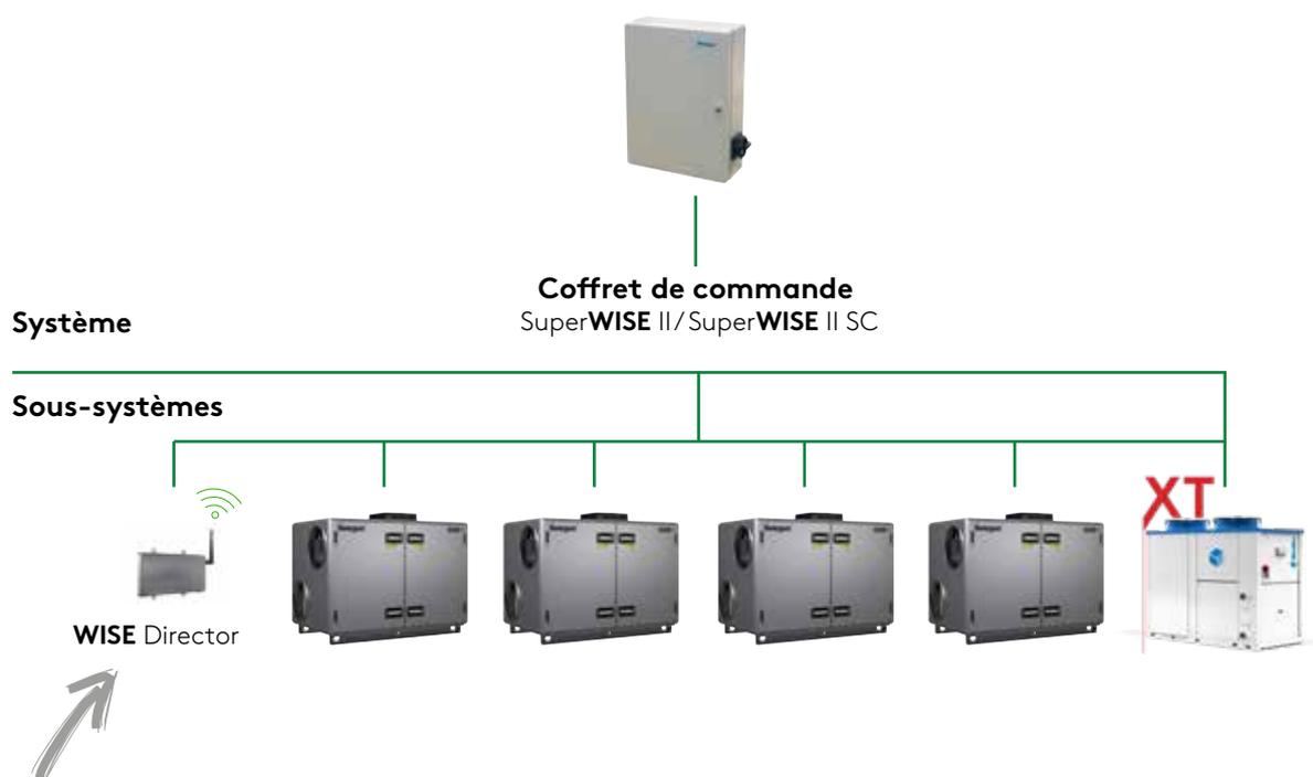
Un module de commande central, **WISE Director**, assure la communication entre le coffret de commande et chaque équipement technique (pompes à chaleur, centrales de traitement d'air, diffuseurs, émetteurs de chaleur, sondes...).
