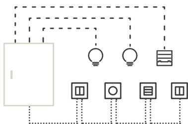
Les interrupteurs communiquent avec les systèmes (éclairage, volets,...) via le boîtier et peuvent ainsi commander n'importe quel système sans devoir être directement reliés.
